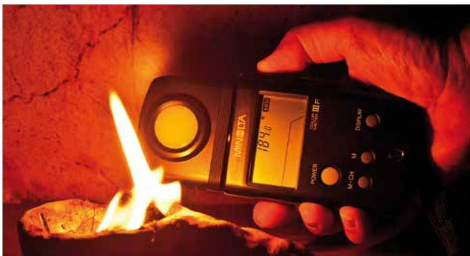
Medición con un termocolorímetro de la temperatura de color de la llama de una lámpara de tuétano.
